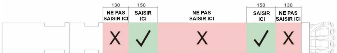
Figure 1 : Emplacements de préhension pour le marteau à circulation inversée BD DRILL
